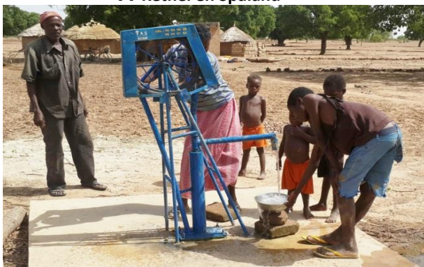
water halen met behulp van een touwpomp
